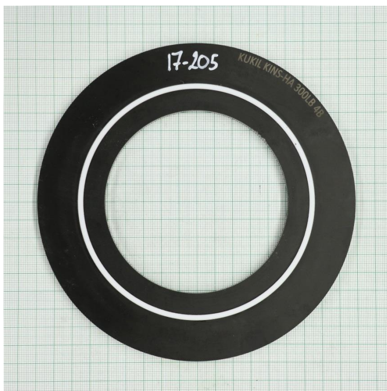
Creep Relaxation Test at 160 MPa - RT (EN 13555)
