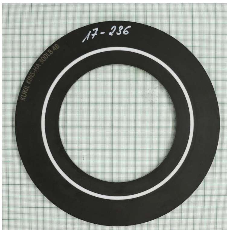
Creep Relaxation Test at 160 MPa - RT (EN 13555)
