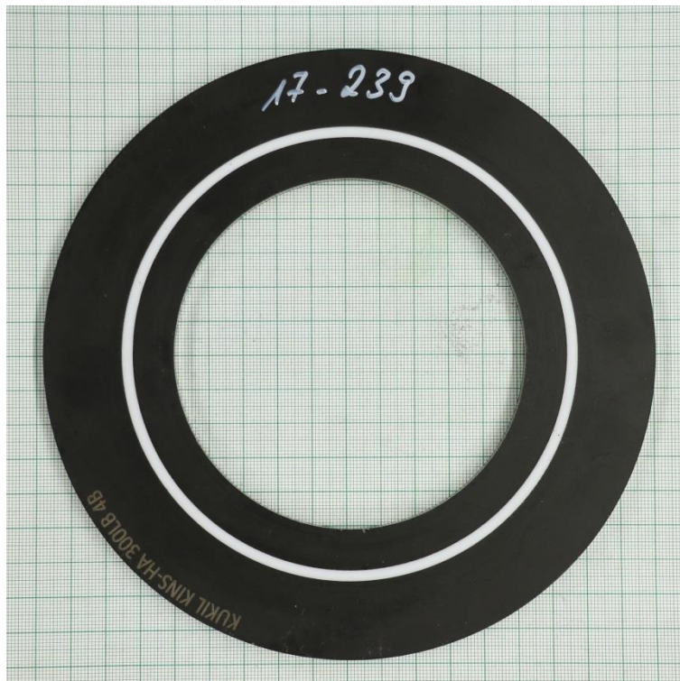
Leakage Test at RT (EN 13555)
